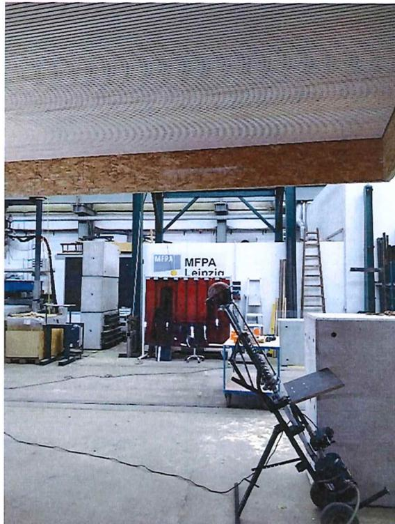
Abbildung A2-1: Versuchsaufbau Deckenelement, Auftreffwinkel 60° - Handball
