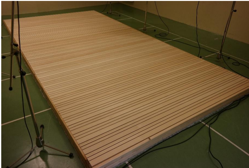
Foto 1 Prüfaufbau und Positionierung im Hallraum
