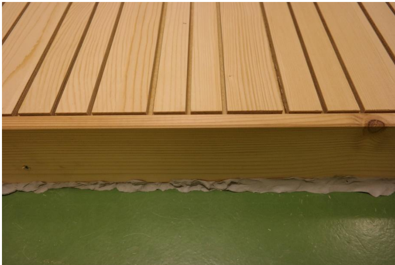
Foto 2 Darstellung des Abschlusses des Prüfmusters mit Kantenabdichtung
